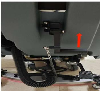
3. Установите водосборный скребок на монтажный кронштейн суппорта, как показано на рисунке. Убедитесь, что фиксирующий винт полностью вошел в паз кронштейна, а затем затяните его.
