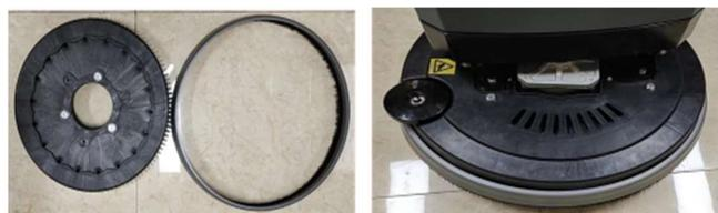
5. Очистите задний водосборный скребок. Поднимите скребок рычагом в верхнее положение, чтобы продлить срок службы водосборных резинок.
