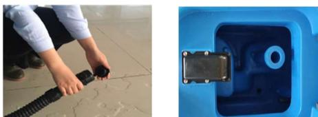
2. Снимите и промойте сетчатый фильтр грубой очистки, расположенный в баке для грязной воды.
